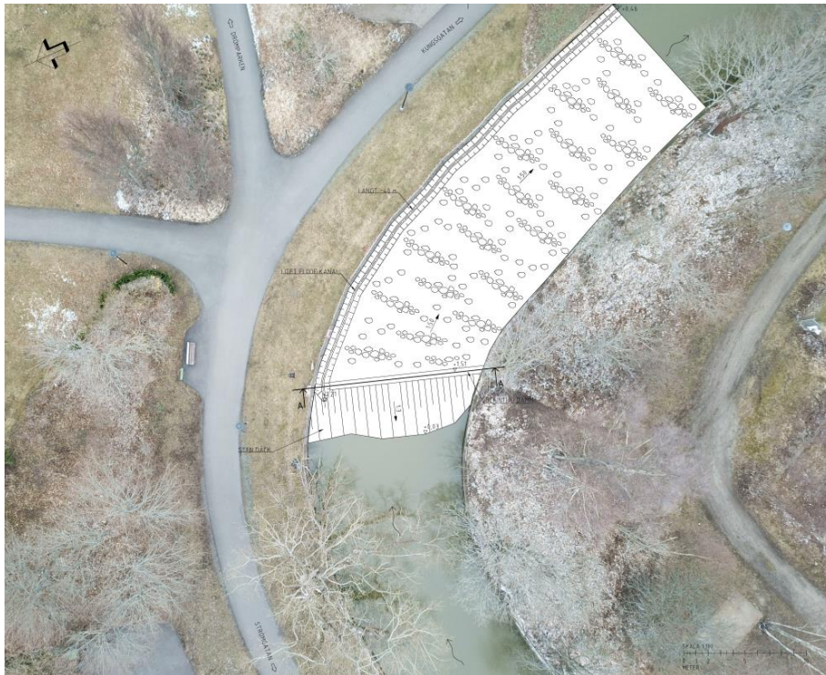
Figur 12. Upptröskling med rak stigränna för lågflöden.
